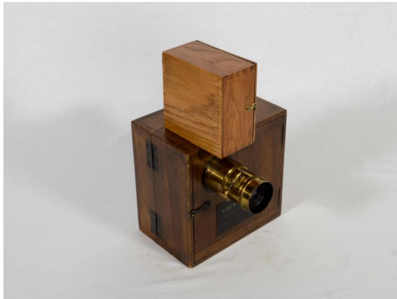
Lumière-Carpentier Cinématographe 35 mm Camera/Printer/Projector Collection Cinémathèque québécoise 1995.0218.01-17. AP TECHNÈS CC BY-SA 4.0
