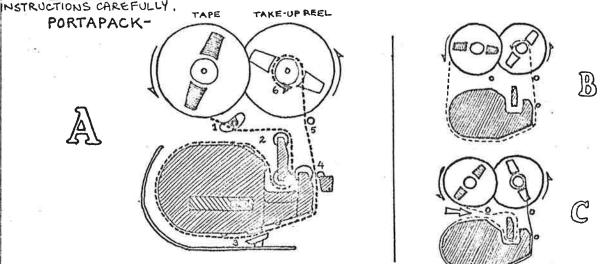
THE EMPTY 'TAKE-UP' REEL SHOULD BE ON THE RIGHT-HAND SIDE . PLACE THE TAPE REEL ON THE LEFT, AND UNWIND ABOUT 21/2 OF TAPE. ONLY THE INSIDE, SHINY SIDE OF THE VIDEOTAPE SHOULD TOUCH THE RECORDING HEADS. HANDLE THE TAPE LIGHTLY BY THE EDGES, TO AVOID GETTING NATURAL GREASE FROM YOUR FINGERS ONTO THE INSIDE OF THE TAPE; DON'T LET THE TAPE LIE ON A DUSTY
